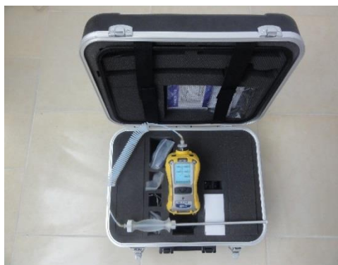
شکل ۱۳-۲ سیستم پرتابل قرائت مستقیم مجهز به سنسور الکتروشیمیایی (MultiRAE Lite / RAE Systems) (تصاویر: نویسنده).
