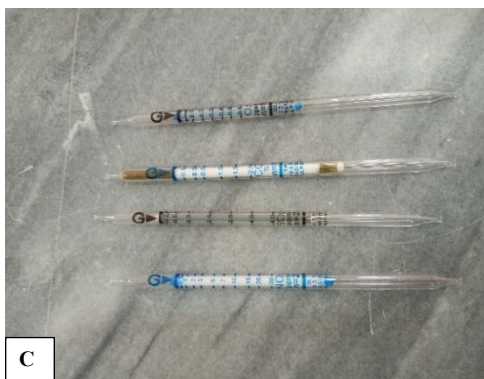
شکل ۱۳-۴ پمپ پیستونی SKC جهت نمونه برداری از هوا برای شناسایی گازها و بخارات زیان آور (شکل های A و B)، لوله های گازیاب به ترتیب از پایین به بالا: دی اکسید نیتروژن، دی اکسید گوگرد، مونوکسید کربن، و اُزن (C)، و لوله گازیاب اُزن در نمایی دیگر (D) (تصاویر: نویسنده).
