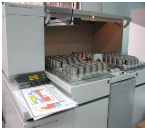
شکل ۱۳-۱۶ دستگاه پراش اشعه ایکس (راست) و فلورسانس اشعه ایکس (چپ) مورد استفاده در مطالعه آنالیز ذرات معلق.
