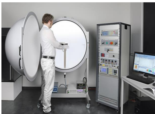
شکل ۱۵-۱ کره جمع کننده اولبريخت برای اندازه گیری شار نورانی.
