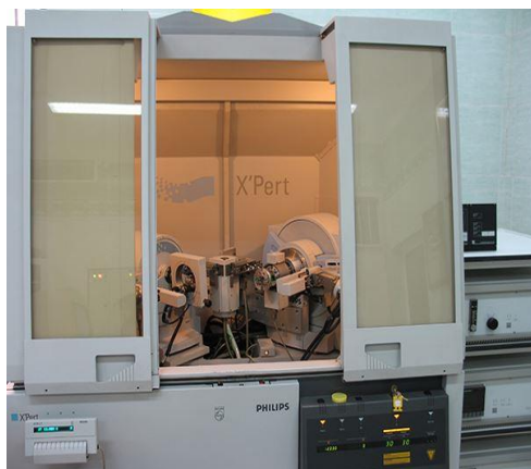
شکل ۱۳-۱۶ دستگاه پراش اشعه ایکس (راست) و فلورسانس اشعه ایکس (چپ) مورد استفاده در مطالعه آنالیز ذرات معلق.
