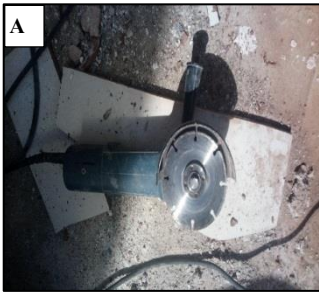
شکل ۴-۵ نمونه‌هایی از تجهیزات کار: سنگ فرز (A) (تصویر: نویسنده) و ماشین مته یا دریل (B و C).
