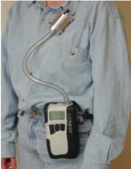
شکل ۱۰-۱۳ نمایی از ایمپکتور آبشاری (راست) و موقعیت ایمپکتور آبشاری هنگام نمونه برداری (چپ).
