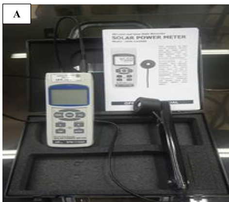
شکل ۱۶- ۶ دستگاه اندازه‌گیری انرژی تابشی (A) (تصویر: نویسنده) و دستگاه WBGT سنج. قابلیت اندازه‌گیری دمای تر، دمای خشک، دمای گوی‌سان، و اندازه‌گیری میزان تشعشع حرارتی به وسیله گوی توخالی (B).
