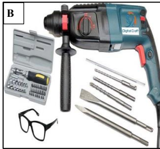
شکل ۴-۵ نمونه‌هایی از تجهیزات کار: سنگ فرز (A) (تصویر: نویسنده) و ماشین مته یا دریل (B و C).
