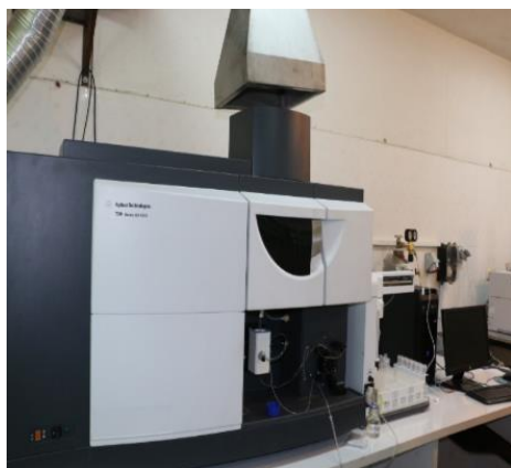
شکل ۱۳-۱۴ طیف‌سنج آرایه‌ای مرئی-فرابنفش (راست)(تصویر: نویسنده) و دستگاه طیف‌سنج پلاسمای القایی جفت‌شده (چپ).
