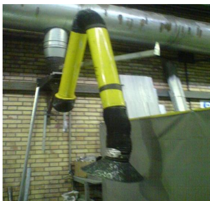
شکل ۴-۶ کابین‌های فیوم جوشکاری (راست) (تصویر از نویسنده) و تهویه موضعی جوشکاری (چپ).
