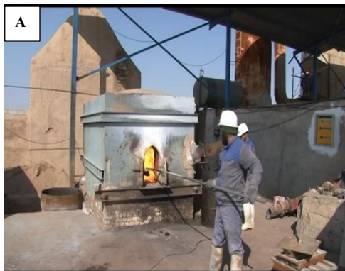
شکل ۱۱-۴ کوره ذوب سرب در واحد بازیافت (A) و شمش ذوب تولیدشده از سنگ معدن یا کوره‌های بازیافتی (B).
