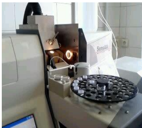
شکل ۱۳-۱۵ دستگاه جذب اتمی و نمونه‌های آماده‌شده جهت تزریق به دستگاه برای آنالیز فلزات سنگین (تصویر: نویسنده).
