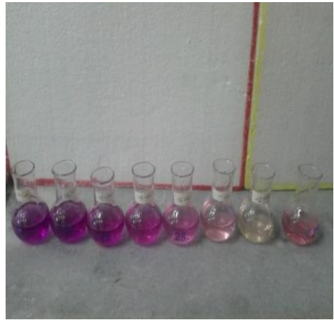
شکل ۹-۱۳ سنجش دی اکسید نیتروژن: استانداردهای تهیه شده برای رسم منحنی کالیبراسیون (راست) و نمونه محیطی جمع آوری شده (چپ) (تصاویر: نویسنده)
