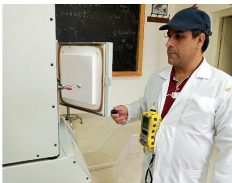
شکل ۱۳-۲ سیستم پرتابل قرائت مستقیم مجهز به سنسور الکتروشیمیایی (MultiRAE Lite / RAE Systems) (تصاویر: نویسنده).
