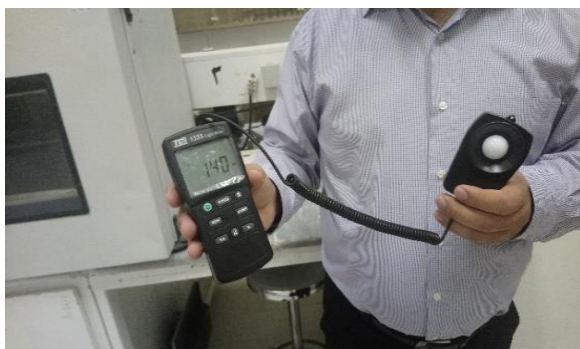
شکل ۱۵-۱۰ نمونه‌ای از دستگاه لوکس متر (مدل TES 1335) برای اندازه‌گیری شدت روشنایی (تصویر: نویسنده).
