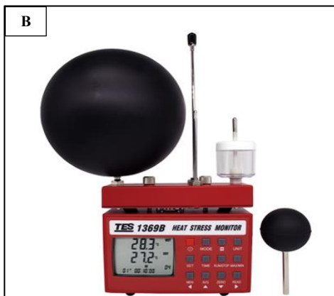
شکل ۱۶- ۶ دستگاه اندازه‌گیری انرژی تابشی (A) (تصویر: نویسنده) و دستگاه WBGT سنج. قابلیت اندازه‌گیری دمای تر، دمای خشک، دمای گوی‌سان، و اندازه‌گیری میزان تشعشع حرارتی به وسیله گوی توخالی (B).
