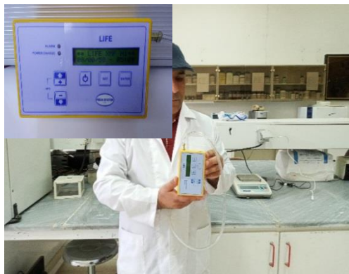
شکل ۱۳-۷ کیسه نمونه برداری گاز و بخار (راست) و پمپ نمونه برداری فردی قابل استفاده در پرکردن کیسه نمونه برداری (چپ) (تصاویر: نویسنده)
