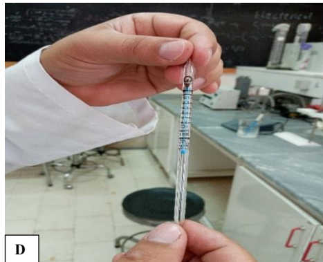
شکل ۱۳-۴ پمپ پیستونی SKC جهت نمونه برداری از هوا برای شناسایی گازها و بخارات زیان آور (شکل های A و B)، لوله های گازیاب به ترتیب از پایین به بالا: دی اکسید نیتروژن، دی اکسید گوگرد، مونوکسید کربن، و اُزن (C)، و لوله گازیاب اُزن در نمایی دیگر (D) (تصاویر: نویسنده).
